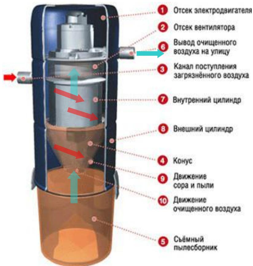
► Силовые агрегаты **VACUFLO True Cyclonic** работают без применения традиционных фильтров, благодаря **уникальному** циклоническому методу очистки воздуха
